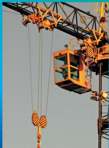
Zahlreiche Maschinen vereinfachen uns den Alltag. Zu den einfachsten Maschinen gehört der Flaschenzug. Hierbei handelt es sich um eine Vorrichtung, mit der man schwere Lasten leichter anheben kann. Im Idealfall, wenn nämlich das Gewicht der Rollen und die Reibungskräfte vernachlässigt werden können, reduziert der Flaschenzug die nötige Kraft. Die Kraft wird je nach Anzahl der Rollen auf die Hälfte, ein Viertel u.s.w. reduziert.
