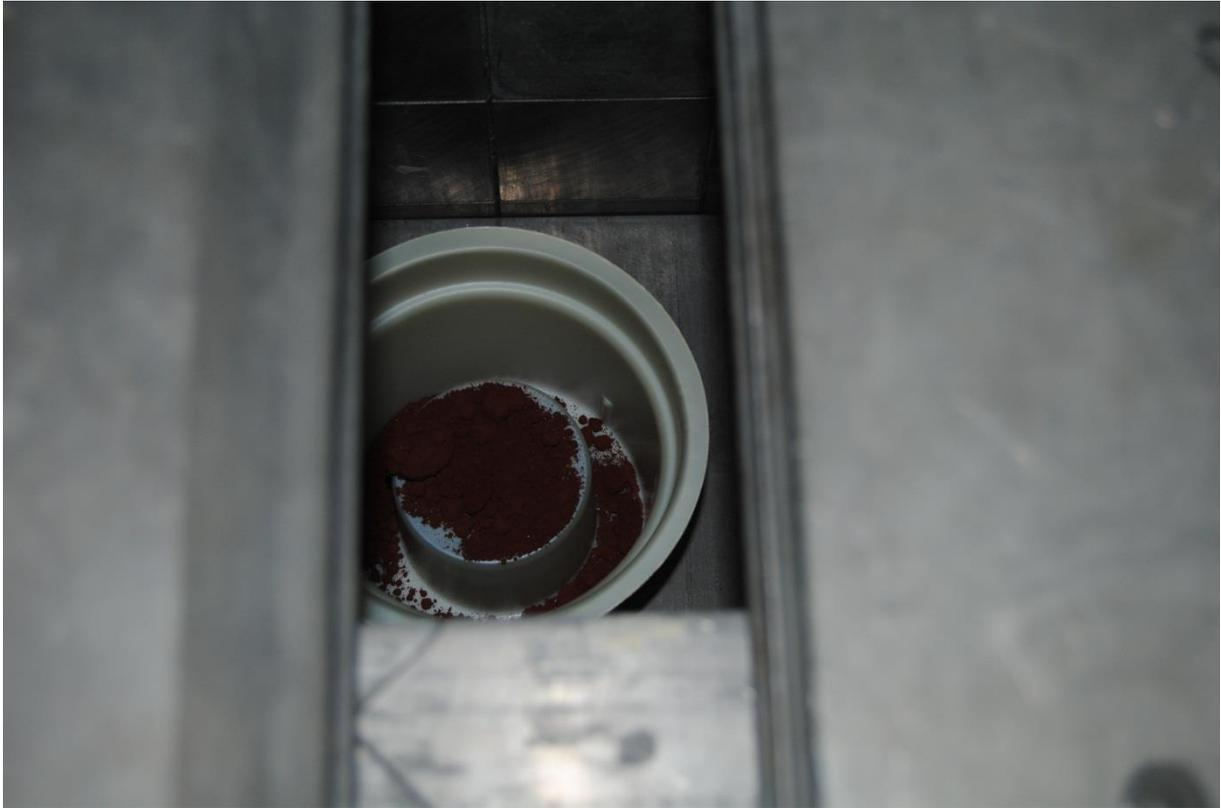
**Abbildung 11: Probe auf dem Germaniumdetektor; Umgeben von Bleiabschirmung**
